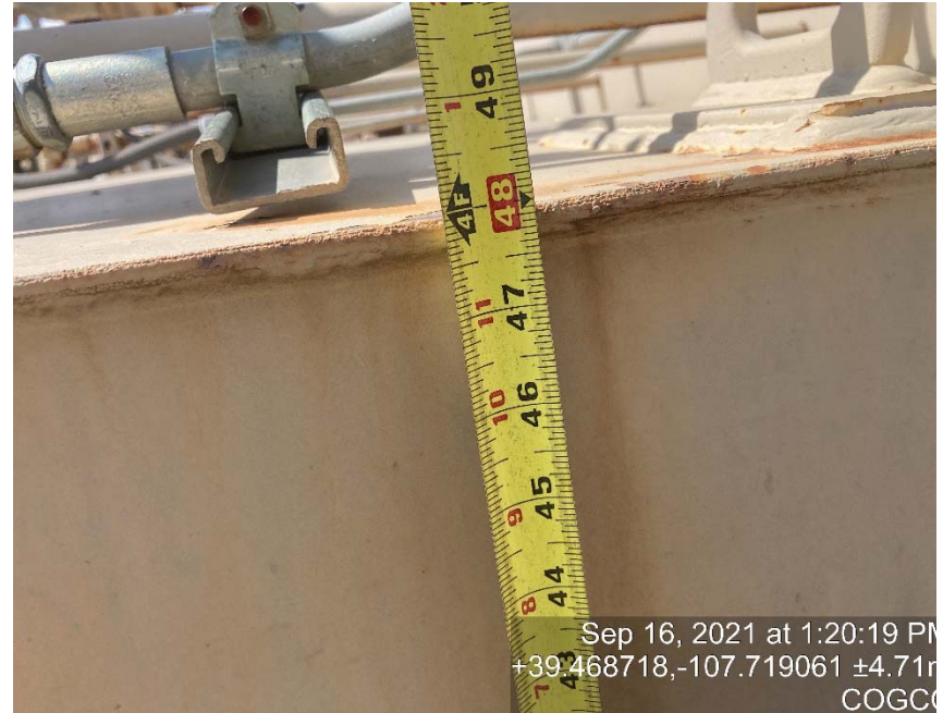
Glycol vessel dimensions (vertical)
