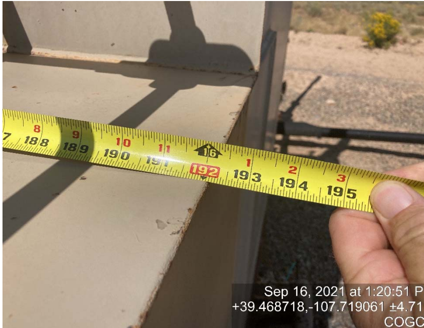
Glycol vessel dimensions (vertical)
