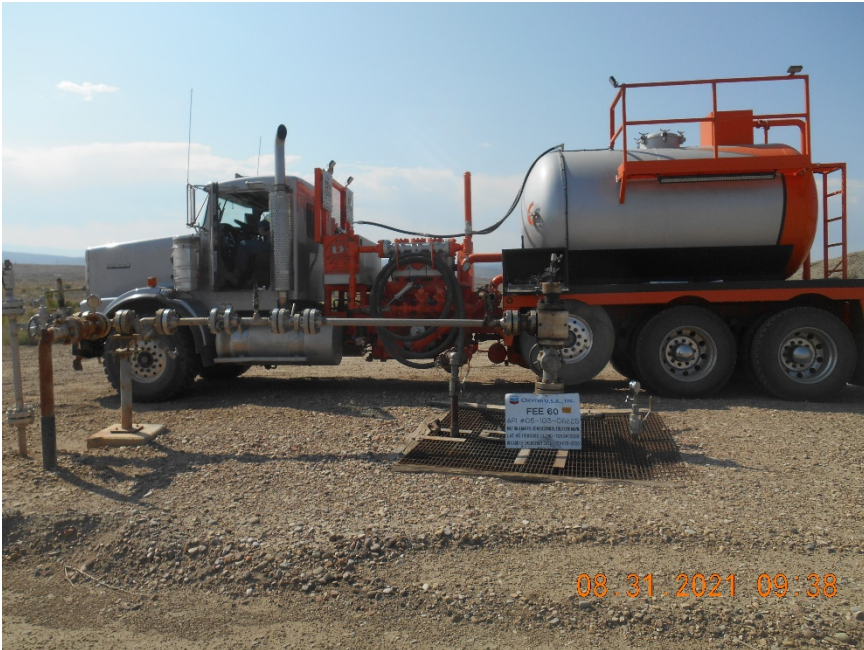
Injection wellhead during MIT
