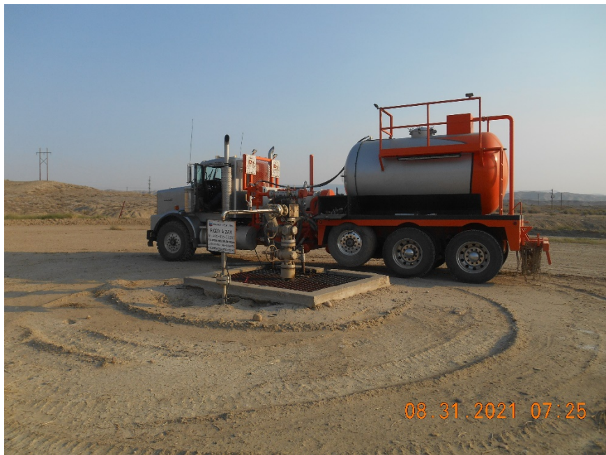
Injection wellhead during MIT
