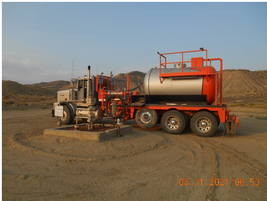
Injection wellhead during MIT
