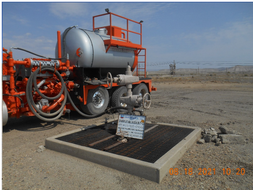
Injection wellhead during MIT
