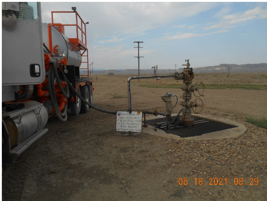
Injection wellhead during MIT
