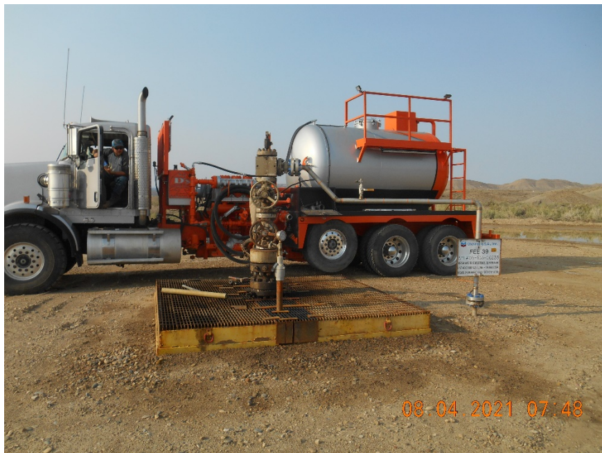
Injection wellhead during MIT
