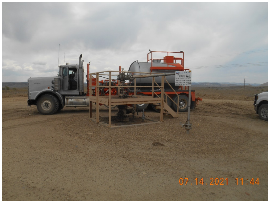
Injection wellhead during MIT
