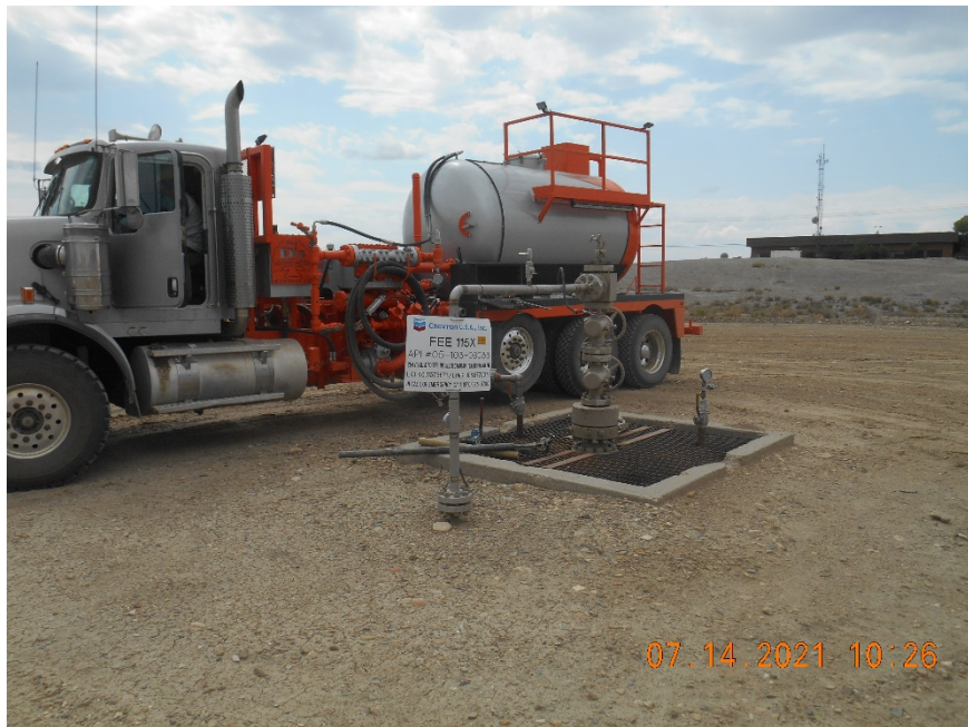
Injection wellhead during MIT
