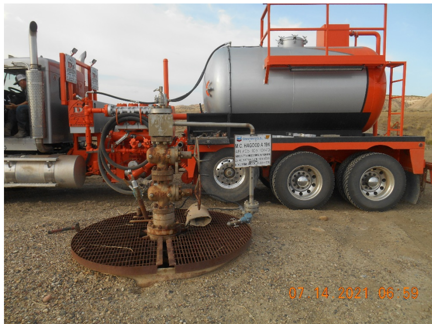
Injection wellhead during MIT
