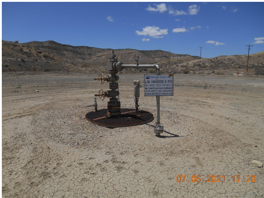
Injection wellhead. MIT to maintain SI/TA status
