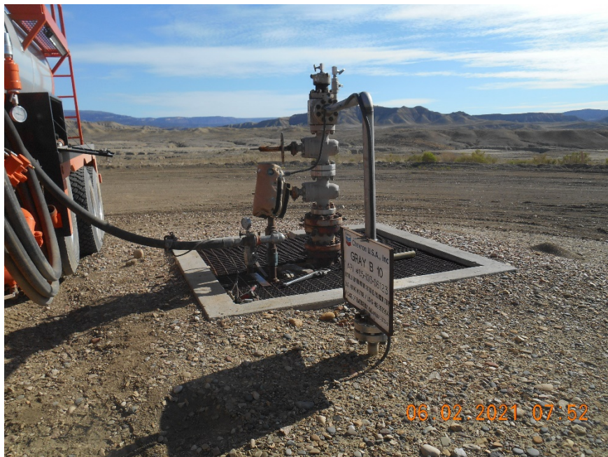
Injection wellhead during MIT
