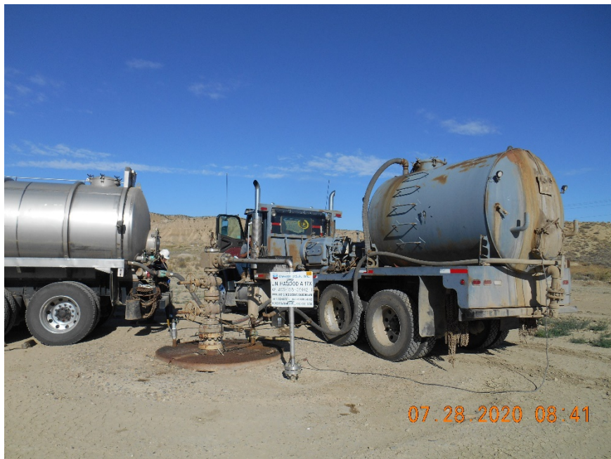
Injection wellhead. MIT to maintain SI/TA status
