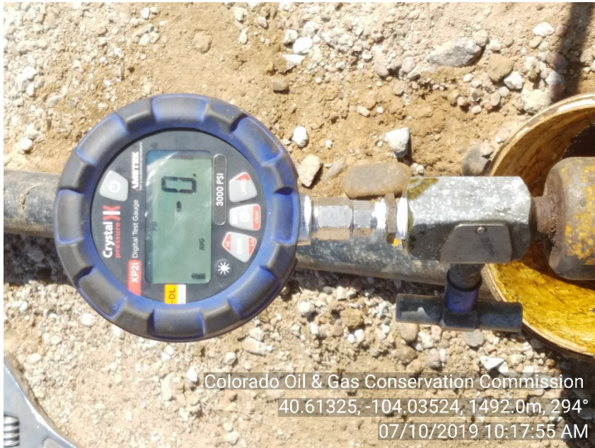
Photo #3 State 36-16 Injection Well Shut-In | SI Pre-Test | UIC - MIT Csg. Press: 0#
