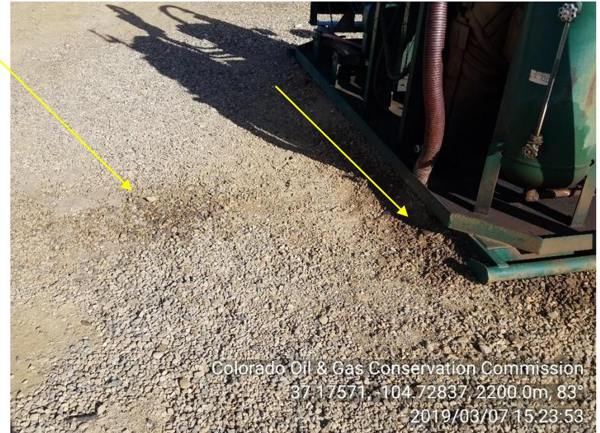
**PHOTO 6: IMPACTED SOIL AROUND COMPRESSOR**
