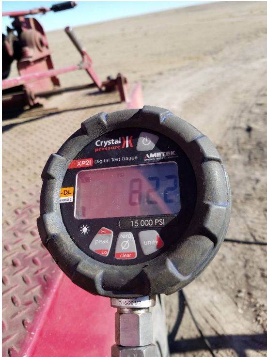
Photo #7 Lilli Unit 8-8 UIC-MIT Csg. Press, 15 min, MIT-End : 822#
