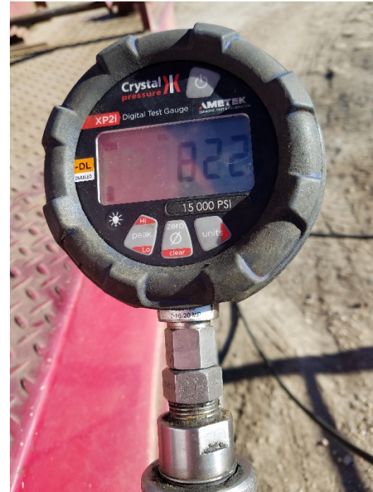
Photo #6 Lilli Unit 8-8 UIC-MIT Csg. Press, 10 min: 822#
