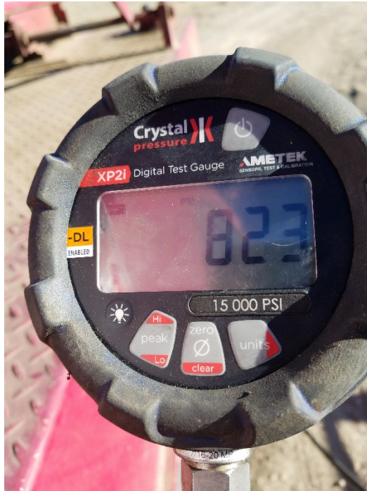
Photo #5 Lilli Unit 8-8 UIC-MIT Csg. Press, 5 min: 823#
