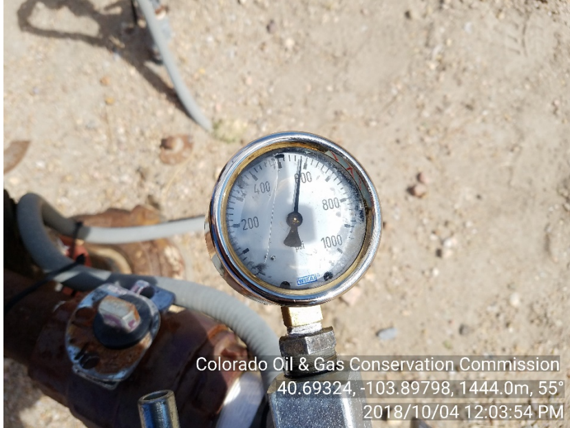
Photo #7 Lilli Unit 8-6 UIC-MIT Csg. Press, 15 min, MIT-End : 580#
