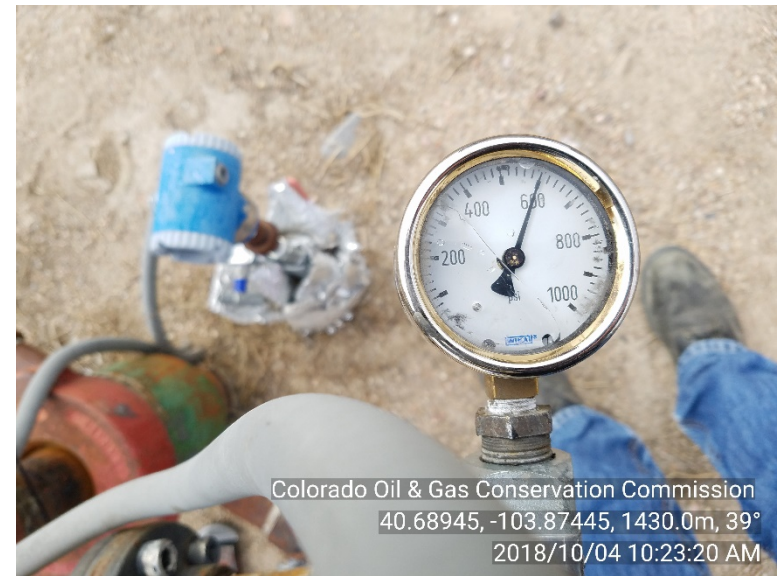
Photo #6 Lilli Unit 12-4 UIC-MIT Csg. Press, 10 min: 600#
