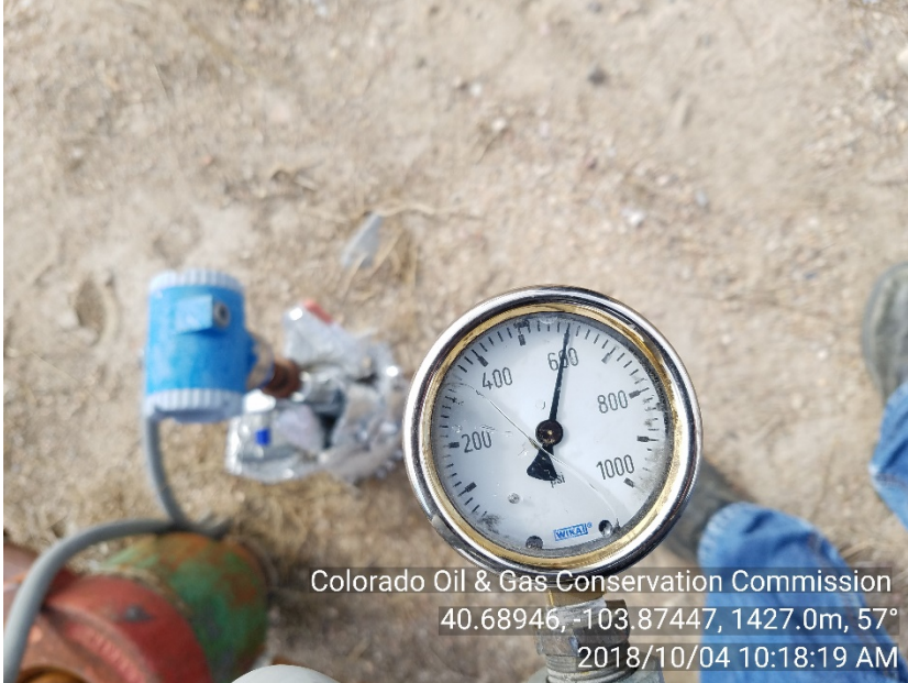
Photo #7 Lilli Unit 12-4 UIC-MIT Csg. Press, 15 min, MIT-End : 600#
