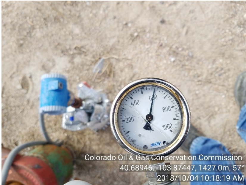
Photo #5 Lilli Unit 12-4 UIC-MIT Csg. Press, 5 min: 600#
