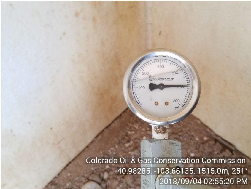
Photo #6 Moyer Unit 11-29 (UIC) UIC-MIT 15-min Csg Pressure: 500# End MIT
